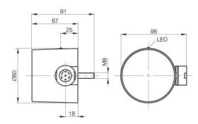
Induktiver Näherungsschalter BES IKJ-S-050-P-2-S-C D80 x 67 Schließer Sn=50mm nicht bündig einbaubar
